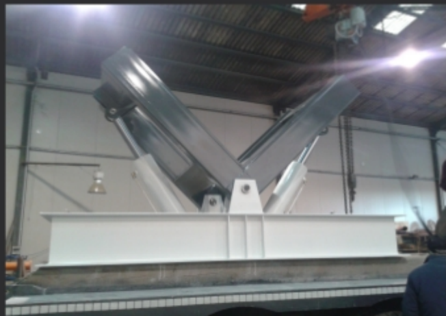
Ribaltabloccchi di marmo e granito da 40 tonnellate
